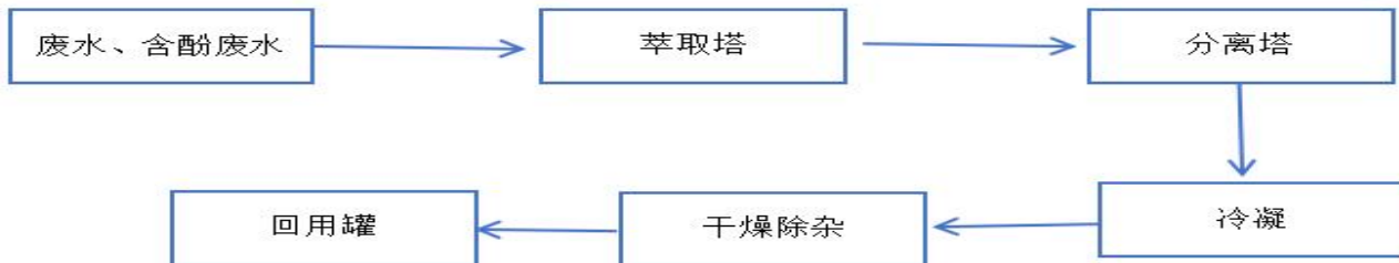
废水回收工艺流程图
