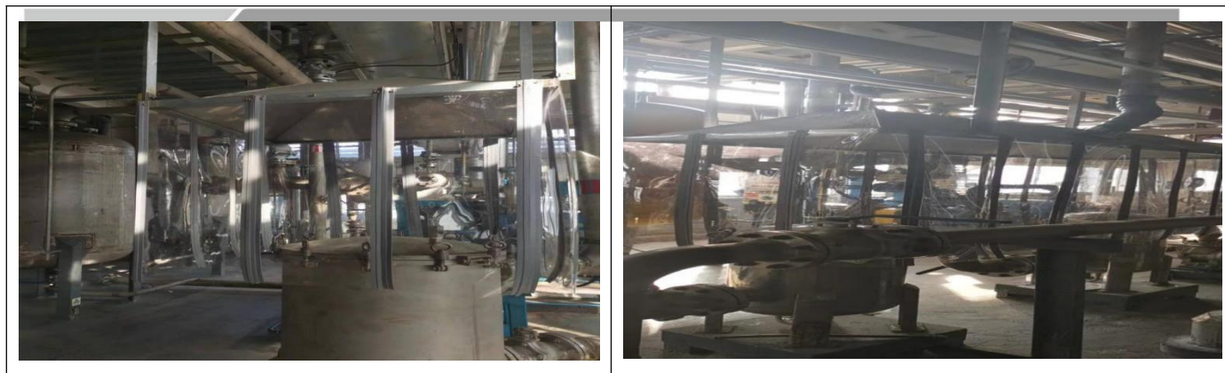
案例 2：原材采取高效密封罐装置存放与管道传输，减少异味的散发
